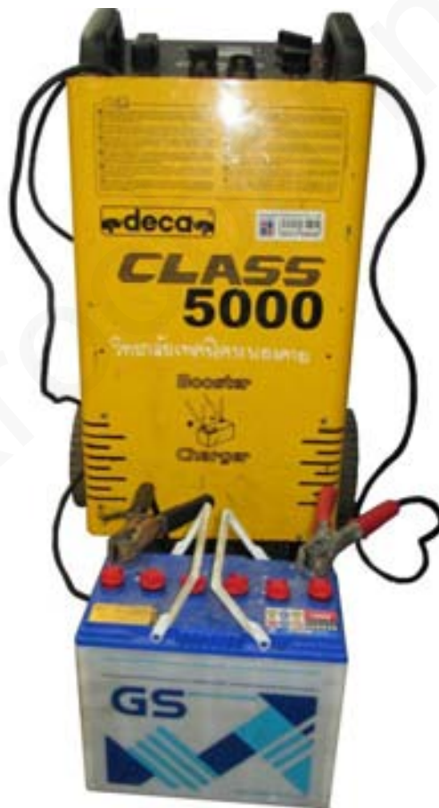
รูปที่ 3.23 การประจุไฟฟ้าเข้าแบตเตอรี่
