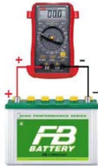
รูปที่ 3.19 ใช้โวลต์มิเตอร์วัดแรงเคลื่อนรวมทั้งหมดของแบตเตอรี่
